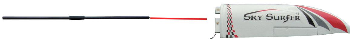
Fixer l'aile sur le fuselage avec le tige de lien installé. Ensuite, installez la deuxième aile principale de l'autre côté et assurez-vous pouvez accéder aux pistes du aileron servo de les connecter à l'y harnais sur le côté du cabine. Ensuite, fixez des ailes principales sur le fuselage avec les vis fournies.
