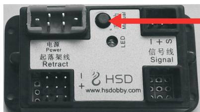
Interrupteur manuel haut/bas du levier d'atterrissage
