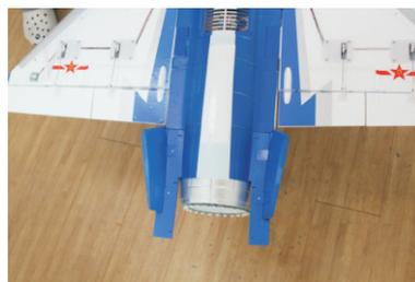
4. Cole a boquilha do tubo de escape como se mostra na imagem. Primeiro, aplique espuma adesiva no interior da zona ranhurada da saída do tubo de escape traseiro, como se mostra na primeira imagem. Depois disso, instale o plástico transparente compressor de ar conduzido na parte onde a cola foi aplicada (segunda imagem). Aplique espuma adesiva na boquilha do tubo de escape e instale (terceira imagem).
