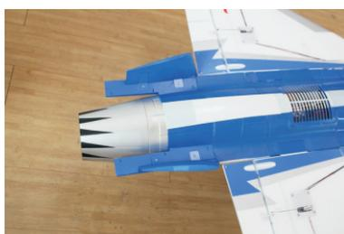
5. Use os parafusos suministrados para instalar o estabilizador vertical na área de montagem no extremo da fuselagem.
