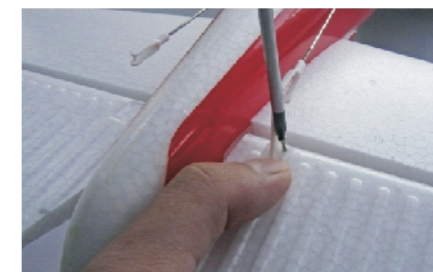
11. Fije las barras de control con tornillos
