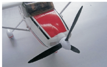
16. En la imagen se muestra la hélice ya instalada en el motor.
