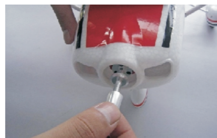
15. Desatornille el casquillo del motor para instalar el cono y la hélice.
