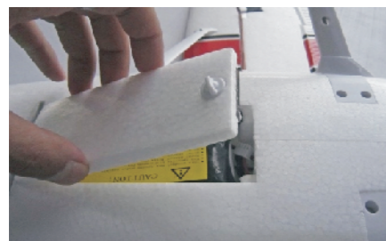
19. Cierre el compartimiento de la batería mediante el interruptor.
