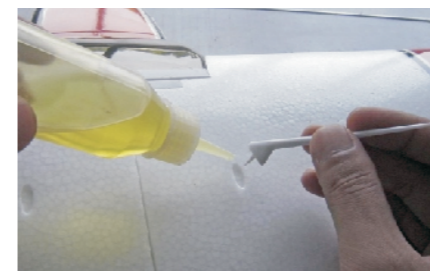
7. Instale las antenas con pega.
