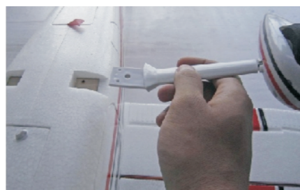
14. Inserte el tren de aterrizaje principal al asiento fijado a ambos lados del fuselaje.
