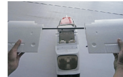
5. Inserte el tubo de fibra de carbono a los agujeros del ala principal.
