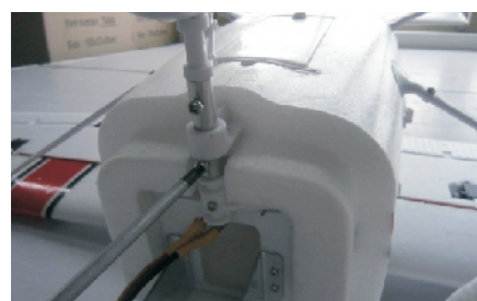
13. Fixe o trem de aterragem central com os parafusos.
