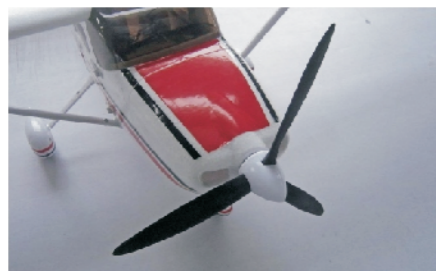
16. Na imagem mostra-se o hélice instalado.
