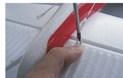
11. Fixe as barras de controle com os parafusos.
