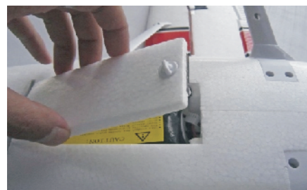
19. Feche o compartimento da bateria mediante o interruptor.
