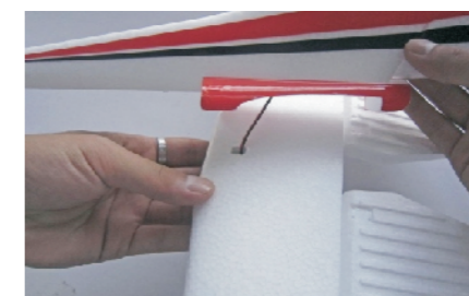
8. Fixe a cauda vertical à cauda horizontal.
