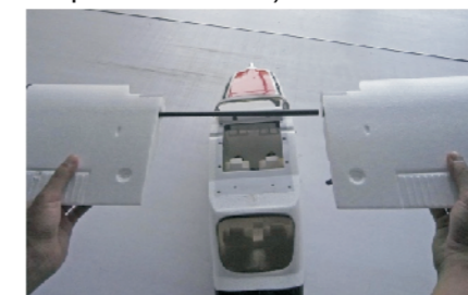
5. Insira o tubo de fibra de carbono nos buracos da asa principal.
