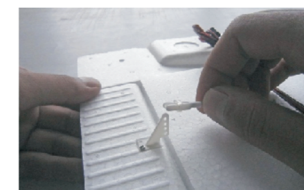
3. Fixe à mão a abraçadeira (no primeiro buraco).
