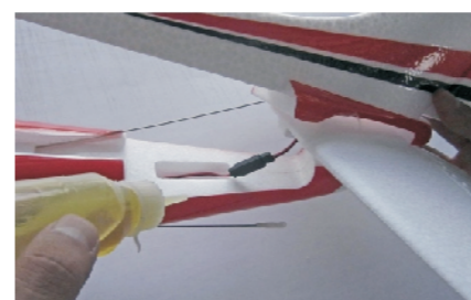
10. Aplique cola na cauda e cole ela na fuselagem.
