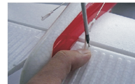
11. Réglez les barres de commande avec des vis.
