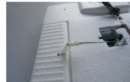
4. Installation des poussoirs est terminée.
