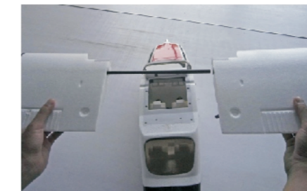
5. insérer le tube de fibre de carbone pour les trous de l'aile principale.
