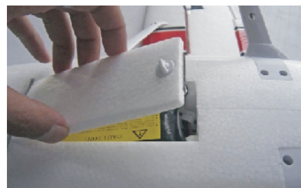
19. Fermez le compartiment de la batterie avec le commutateur.
