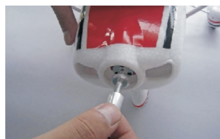
15. Dévissez le bouchon du moteur pour installer l'hélice et le cône.
